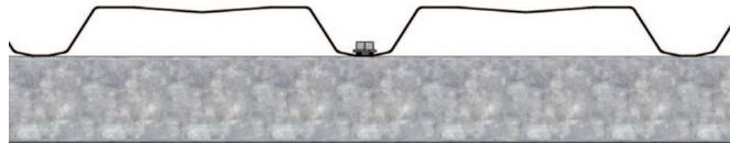
Les fixations ne doivent pas être placées à moins de 25 mm du bord de la tôle au niveau des zones sablière et faîtière.
