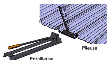
Des outils spéciaux sont nécessaires pour le montage des toitures KLIPLOK® et TRIMDEK®.
