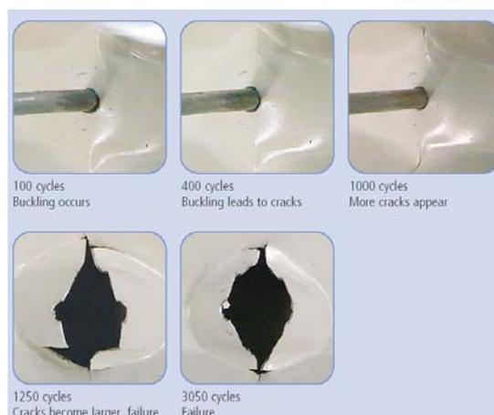
Système d'assemblage traditionnel (calotin + rondelle + fixation) testé dans les mêmes conditions
