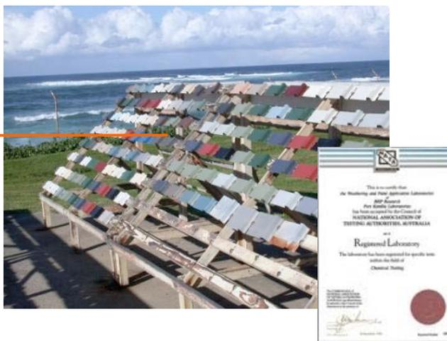
Ces essais permettent de nous engager entièrement sur les performances de nos produits utilisés en climat subtropical à fort U.V. L'ensemble de notre gamme d'acier pré peint est conforme à un classement C5-M pour la résistance à la corrosion ; Ruv4 pour la résistance aux U.V. selon la norme NF EN 10169 et un classement VI selon la norme XP P 34301.
