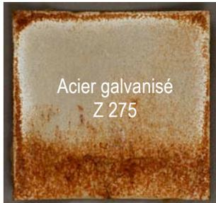
L'acier ZINCALUME® a une résistance à la corrosion meilleure que l'acier galvanisé.
