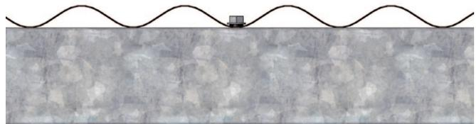
Les tôles doivent être fixées uniquement en sommet d'onde pour la toiture, et en sommet ou creux d'onde pour le bardage.
